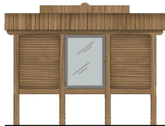
Element 2: 3S1, 3 pola, słupy, 1 gablota skala 1:50
