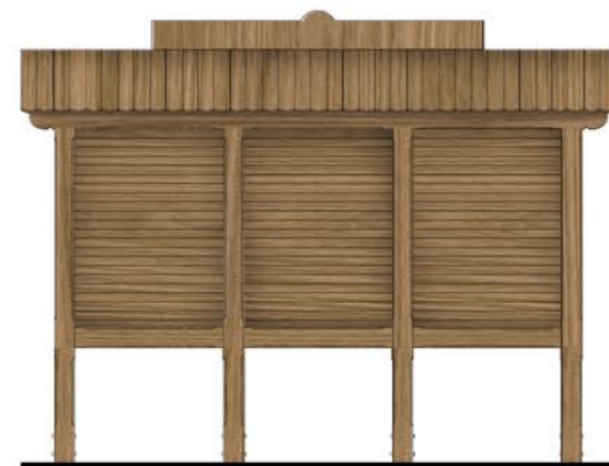
Element 3: 3S0, 3 pola, słupy, 0 gablot skala 1:50
